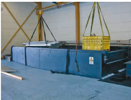
Beizung von Produkten aus Edelstahl im Tauchbad
